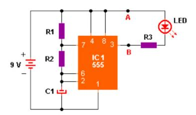
En este esquema marqué los puntos A y B, allí puedes conectar un pequeño parlante (como los de PC), ahora cambia C1 por un capacitor de cerámica (el que tengas a mano, cualquiera va bien), intercala un potenciómetro de 100k entre R2 y el pin 6. Si haces esto obtendrás un generador de sonido.
