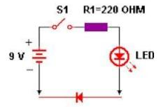
Su mayor aplicación se encuentra en las fuentes de alimentación . Por cierto, el utilizado aquí es un diodo común del tipo 1N4004. Prueba con otros.
