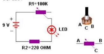
Ahora bien, los extremos A y B del potenciómetro son indistintos ya que la resistencia entre ambos es constante y en nuestro circuito es de 100 k, mientras que la resistencia entre cualquier extremo y el cursor C depende de la posición de este último, pero su máxima resistencia será 100 k.
