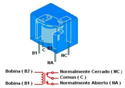
**B1 y B2:** Son los terminales de alimentación de la bobina, cuando circule corriente por ellos el relé se activará cambiando de posición su interruptor interno y el terminal C se conectará con el terminal NA. Veamos ahora un circuito de aplicación...
