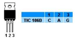
El SCR es una llave electrónica, que se activa cuando se aplica un pequeño voltaje positivo a su compuerta **G** (gatillo). No creas tan fielmente en todo lo que yo digo, monta el circuito y pruébalo.
