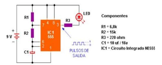
Observa la polaridad de la fuente respecto al LED..., te habrás dado cuenta que la única forma de encenderlo es que el **pin 3** de **IC1** sea negativo. Y lo será..., observa la onda rectangular de los **pulsos de salida** ..., cuando esté arriba será (+) o 1, y el LED estará apagado. Cuando esté abajo será (-) o 0, entonces el LED se encenderá. Según la señal de salida el LED encenderá de forma alternada.
