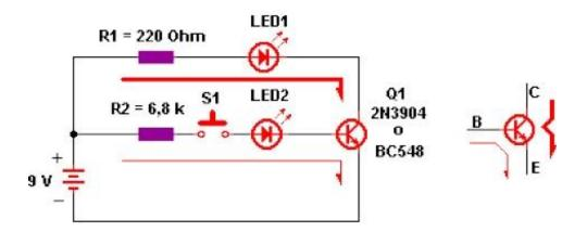
Nuevamente la corriente de base controla la corriente de colector para producir el efecto de AMPLIFICACIÓN.
