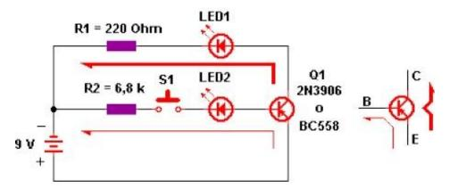
Cuando acciones **S1** llegará una cierta cantidad de corriente a la base del transistor, esta controlará la cantidad de corriente que pasa del Colector al Emisor, lo cual puedes notar en el brillo de los LED's.
