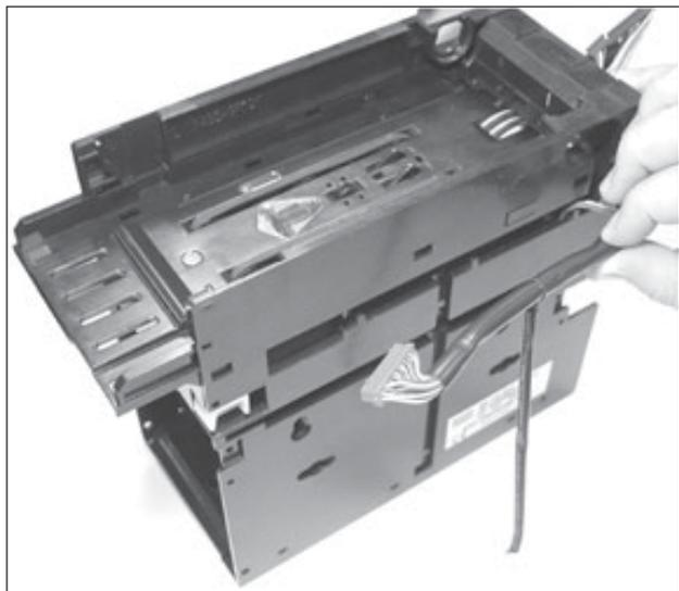
8. Desconecte los cables a un lado de la caja.
