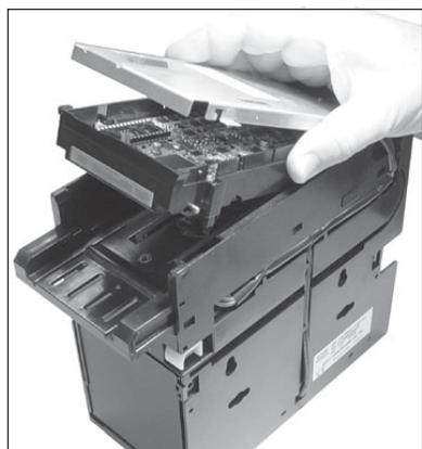
2. Empuje la tapa de la CPU hacia delante levemente para abrirla.
