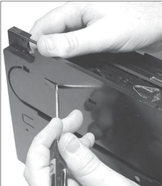
10. Coloque un destornillador de cabeza plana debajo de la lengüeta del lado y levántela.
