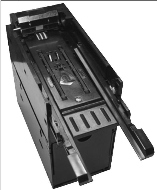
6. Extraiga las guías laterales tirando hacia delante y levantando.
